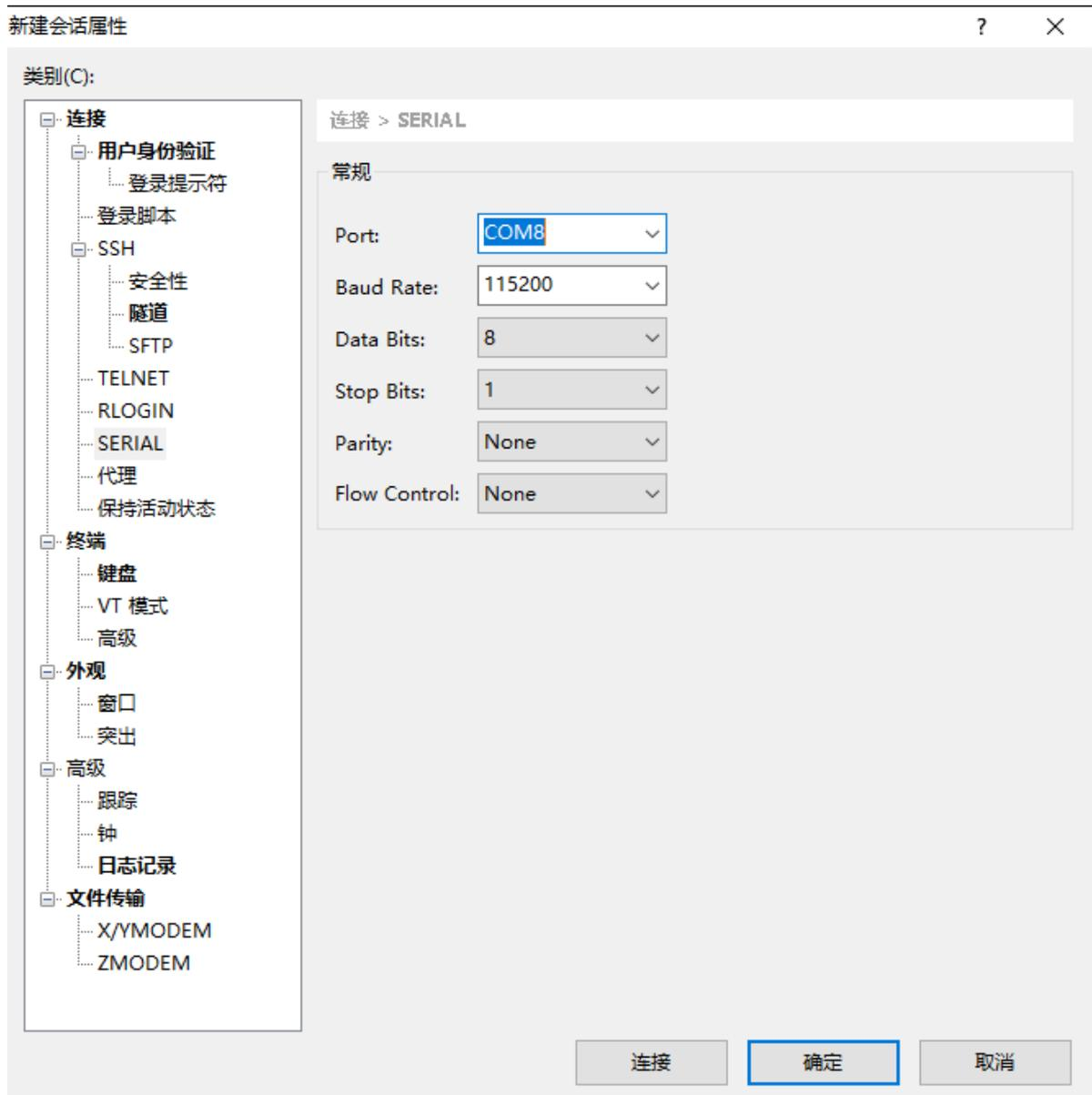
点击连接即可，接着通过Zero板上的USB给zero供电(其实可以通过usb转串口模块的5v或者3.3v给zero供电，但是由于一旦将5v接到不该接的引脚，板子可能立刻升天，所以不是很推荐)，供电后可以看到Xshell上输出了启动信息，没一会内核启动后板上的灯还亮了，在闪烁，以root用户登录（没有密码）
