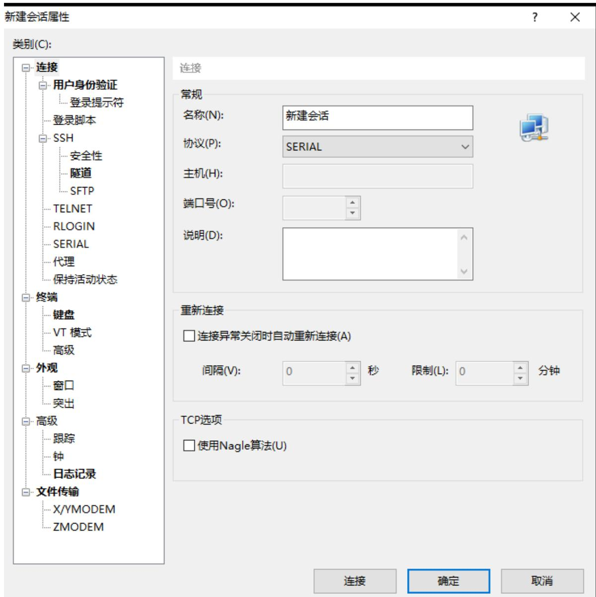
配置波特率(Baud Rate)为115200,端口(Port)一般可以通过下拉菜单选得, 如果你只插了一个串口设备就只会有一个COM:
